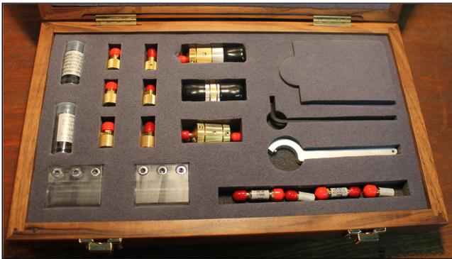
Fig. 4. Kit TRL con conector 3.5mm hasta 32 GHz.
