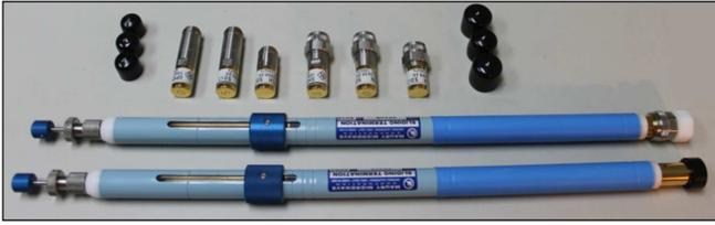
Fig. 2. Kit TOSM con conector Tipo-N hasta 18 GHz.
