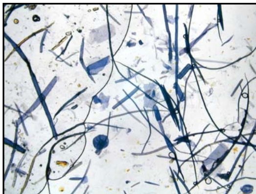
Foto N° III.5: Material fibroso correspondiente a la pasta de bagazo de caña de azúcar, tercer uso (objetivo 4X)
