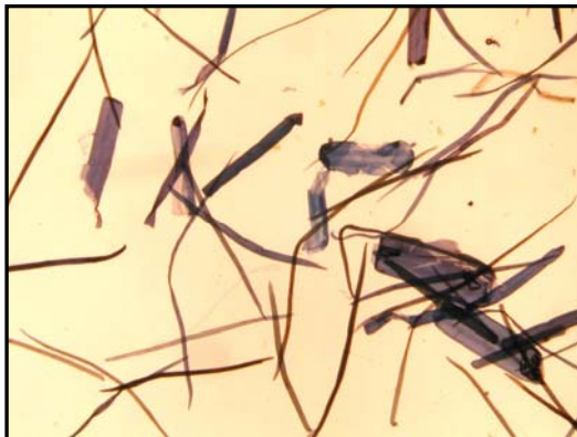
Foto N° III.1: Material fibroso retenido en malla 100 correspondiente a la pulpa de bagazo de caña de azúcar, primer uso (objetivo 10X)
