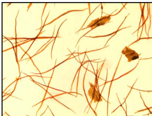
Foto N° III.2: Material fibroso retenido en malla 14 correspondiente a la pulpa de bagazo de caña de azúcar, primer uso (objetivo 4X)
