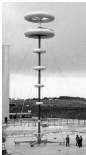
Fig. 3.39. Divisor de tensión capacitivo amortiguado serie para 6 MV de tensión impulso.
