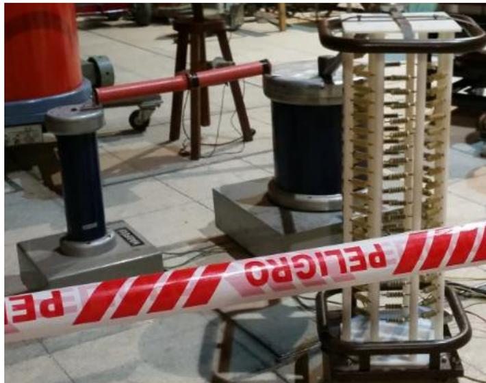
Fig. 3.6. Circuito generador de tensión continua hasta 150 kV y divisor resistivo.
