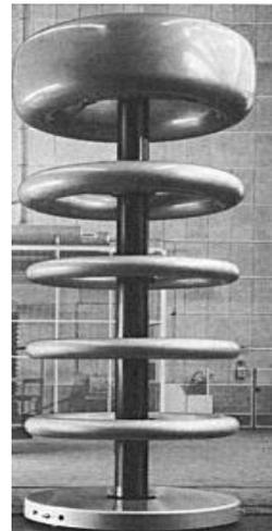
Fig. 3.26. Divisor de tensión resistivo de campo controlado.
