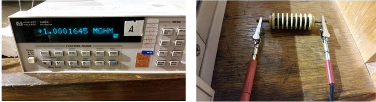
Fig. 5.2. Medición de las resistencias del divisor resistivo.
