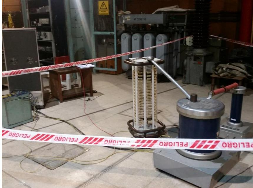
Fig. B.3. Equipo generador de  $AT_{cc}$ .
