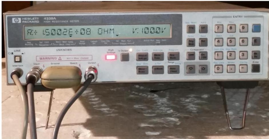
Fig. 5.4. Medición de resistencia de alta.
