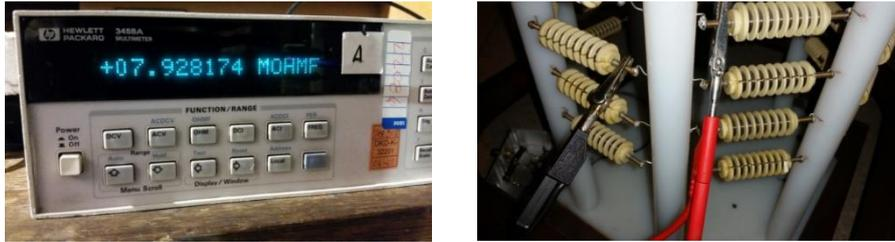
Fig. 5.3. Medición de una serie de 8 resistencias
