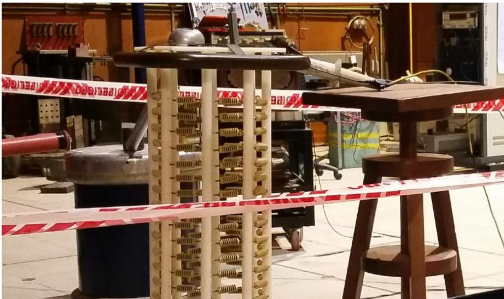
Fig.5.11. Medición de la tensión aportada al divisor con una punta de MT.
