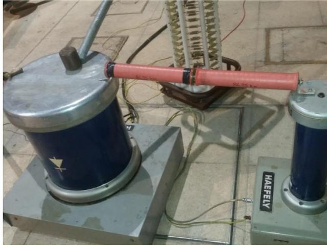
Fig. B.2. Resistencia de amortiguamiento entre modulo rectificador y divisor de medición.
