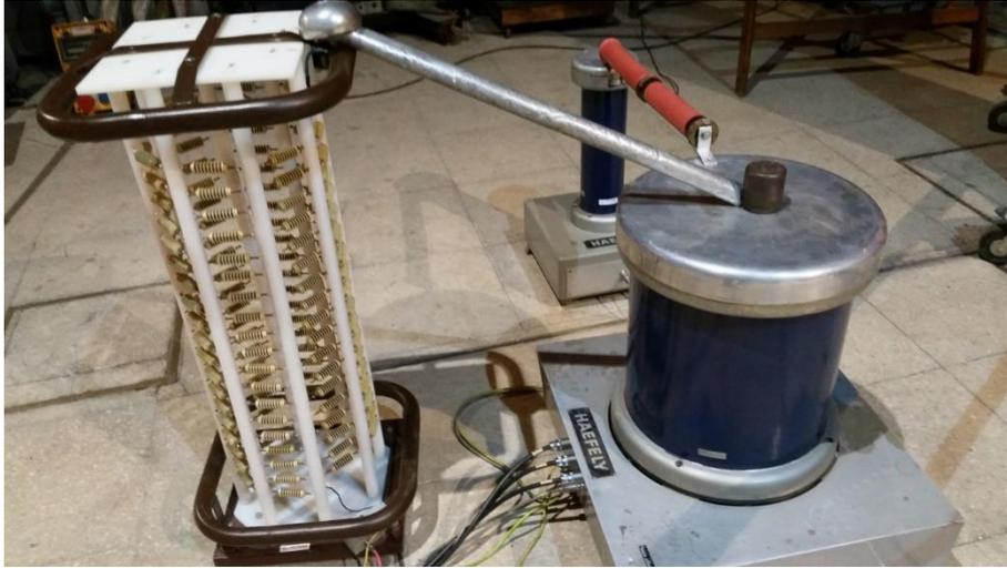
Fig. 5.12. Circuito generador y divisor resistivo.
