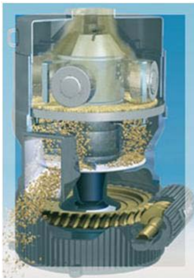
Figura 4.3: Prensa pelletizadora donde se observa la matriz plana y los rodillos
