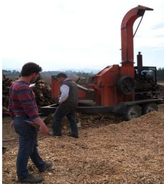
Figura 2.4: Chipeadora marca Deisa de 150 Hp. Ingenio Fronterita
