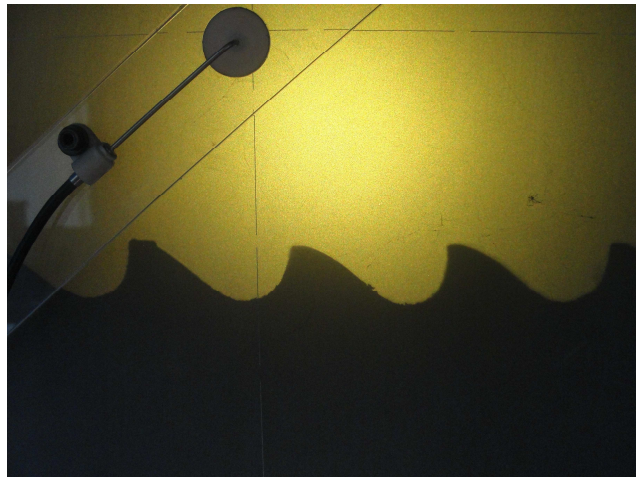
Figura 5 Dentado correspondiente a una hoja de sierra marca A (50x)
