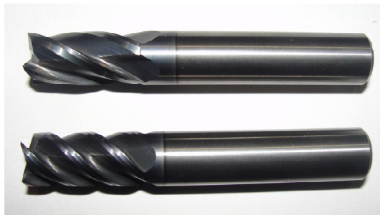
Figura 1. Imagen de una fresa de 30° (arriba) y otra de 45°
