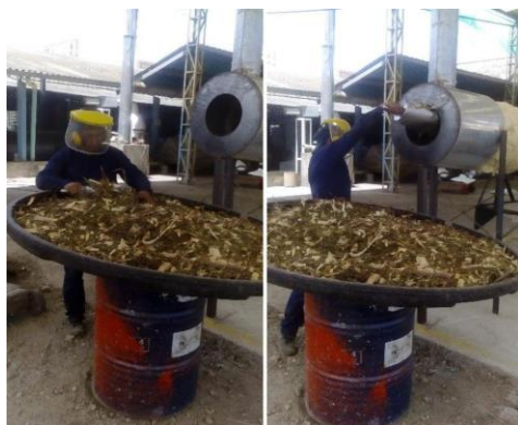
Figura 7. Muestras de podas secadas al ambiente alimentadas manualmente al horno (Fuente: propia, instalaciones de Tecsol, 2015.)
