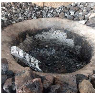
Figura 3. Horno de pozo. (Foto: Marlene Sánchez, 2020, Etúcuaro, México).
