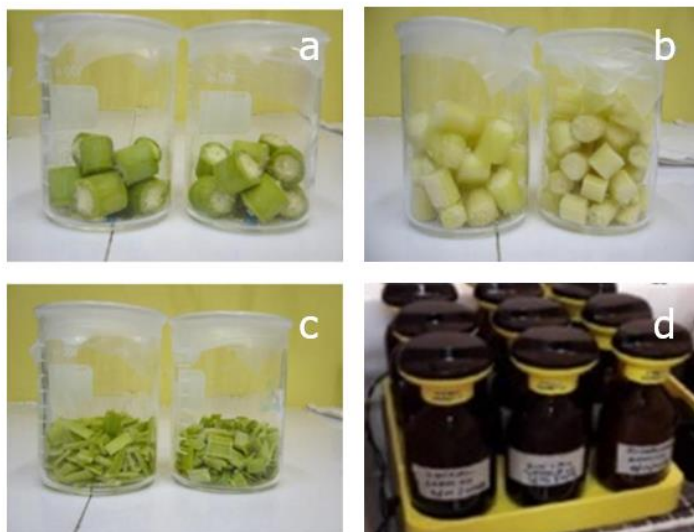
Figura 5. Preparación de reactores batch: a) masa de Saccharum spontaneum L. completa; b) Médula de Saccharum spontaneum L. ; c) Tallo de Saccharum spontaneum L. ; d) Reactores batch en sistema Oxítóp. (Fuente: Deago, 2014, Panamá).
