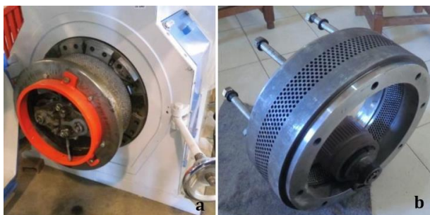
Figura 4. a) Prensa Pelletizadora. b) matriz (Fuente: Martínez Pulido, Tucumán, 2019).
