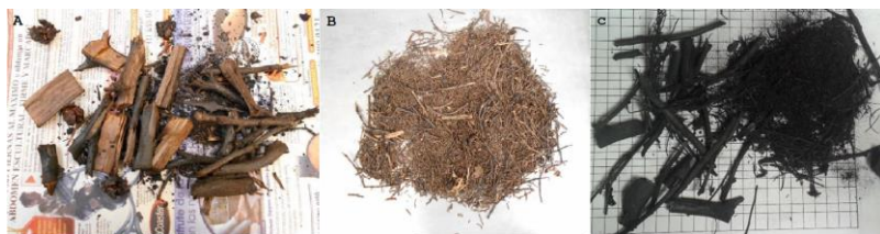
Figura 4. Diferencia entre biomasa torrefactada y carbonizada. A) Muestra de Acacia ( Acacia dealbata ) (ramas) torrefactada en horno A 230°C. B) Muestra de Pino Ciprés ( Cupressus lusitanica ) Torrefactada en estufa a 150°C. C) Muestra de Acacia Dealbata torrefactada a 300°C. (Fuente: elaboración propia. Instalaciones de Tecsol, 2015.)
