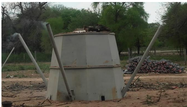
Figura 2. Horno metálico transportable distribuido en zonas rurales de Argentina por el MAyDS de la Nación. (Fuente: Rolando Tévez, Chaco, 2021).
