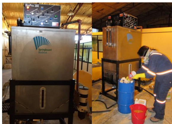
Figura 2. Vista de Planta Piloto de producción de biodiesel, y de operación de carga de planta. (Fuente: UMAG, 2019, Departamento Ing. Química).
