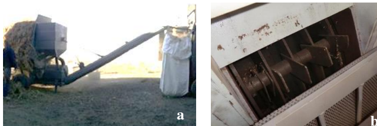
Figura 3.- Maquinaria para el acondicionamiento de tamaño de la biomasa. a) máquina desmenuzadora. b) Molino de martillo (Fuente: Martínez Pulido, Tucumán, 2019).
