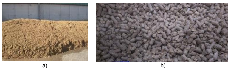
Figura 2. Bagazo de cerveza bruto y pelletizado. Donde: a) BSG bruto y b) pellets de BSG (Fuente: Pérez, 2017, Soria España).
