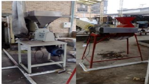
Figura 6. Molinos. A) Molino de martillos. B) Molino de discos. (Fuente: propia, instalaciones de Tecsol, 2015.)
