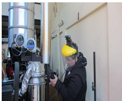
Figura 8. Mediciones de gases de emisión del motor (Fuente: Foto CERE-UMAG, 2014).
