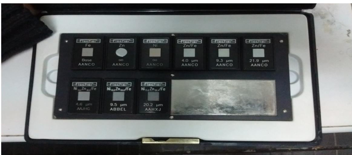
**Conjunto de patrones que se usan en el equipo de Fluorescencia para cada tipo de recubrimiento. Fotografía realizada por Roy Feldman.**
