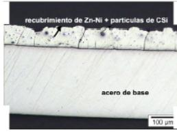
Figura 3. Fotografía obtenida con microscopio óptico. Corte transversal del acero con recubrimiento de Zn-Ni + partículas de CSI incorporado. Se embaldió el material en resina epoxi, pulido después del curado.
