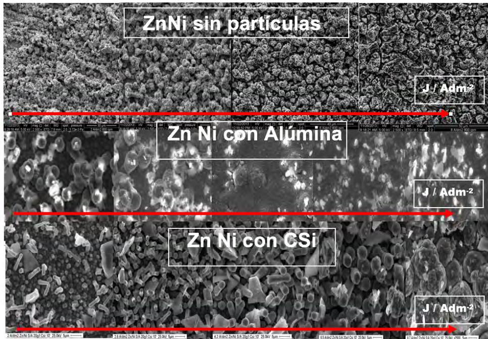
Figura 37. Fotomicrografías para obtener Microestructuras por SEM. Las muestras con el recubrimiento fueron obtenidas en el laboratorio mediante electrodos enfrentados a densidades de corriente crecientes de 2 \text{ Adm}^{-2} , 4 \text{ Adm}^{-2} , 6 \text{ Adm}^{-2} , 8 \text{ Adm}^{-2} , 10 \text{ Adm}^{-2} . Movimiento a lo largo del cátodo a 1 cm de distancia mediante un sistema que mueve la solución a 1 \text{ cms}^{-1} siendo la temperatura T de 30 \text{ }^\circ\text{C} y el pH 3,8.
