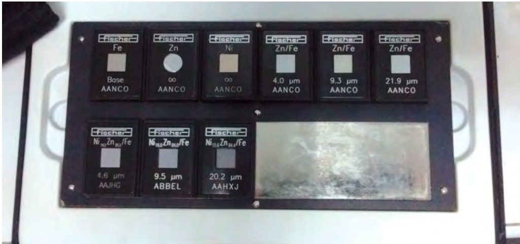
Imagen 9. Conjunto de patrones que se usan en el equipo de Fluorescencia para cada tipo de recubrimiento.
