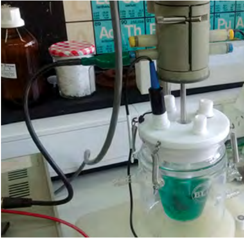
Imagen 4. celda hermética con electrodo de acero sumergido en la solución de electrólisis. El electrodo de acero está conectado con bronce roscado a una barra del Sistema rotatorio.
