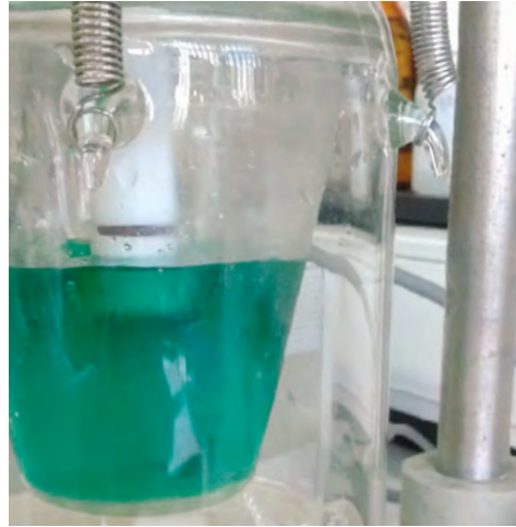
Imagen 5. celda con electrodo de acero removible
