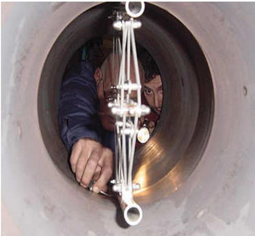
Medición de error de forma en tubo Venturi
