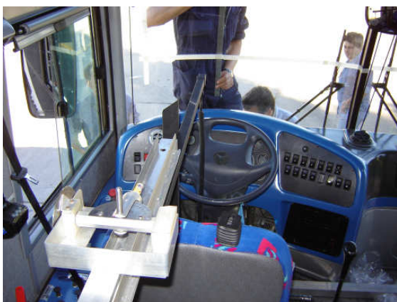
Fig. 3: Montaje del Tangenciómetro y marcado del área de visión.
