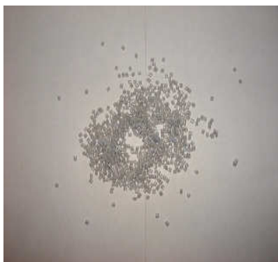
Foto 2. Pellets de PET-PCR descontaminados cristalizados.
