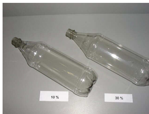
Foto 4. Botellas fabricadas con 10 y 30% de PET-PCR descontaminado y PET virgen.
