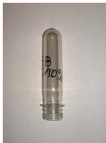
Foto 3. Preforma fabricada con 10% de PET-PCR descontaminado y PET virgen
