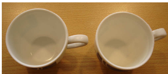
Fig. 1: taza sin uso (E) (a la izquierda) y luego del ensayo de migración con uso repetido (a la derecha).
