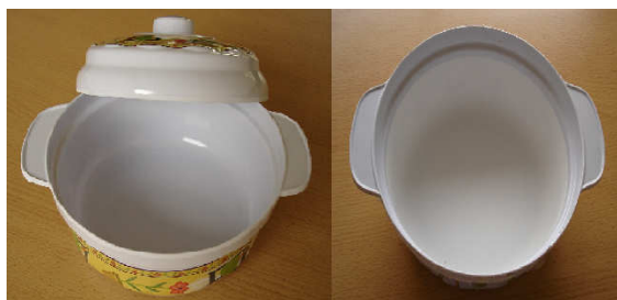
Fig. 2: cacerola sin uso (B) (a la izquierda) y luego del ensayo de migración con uso repetido (a la derecha).
