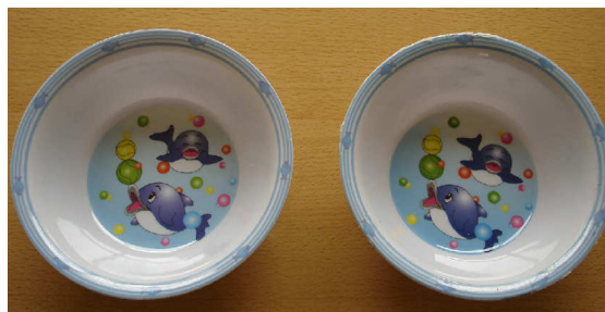
Fig. 3: plato hondo sin uso (D) (a la izquierda) y luego del ensayo de migración con uso repetido (a la derecha).
