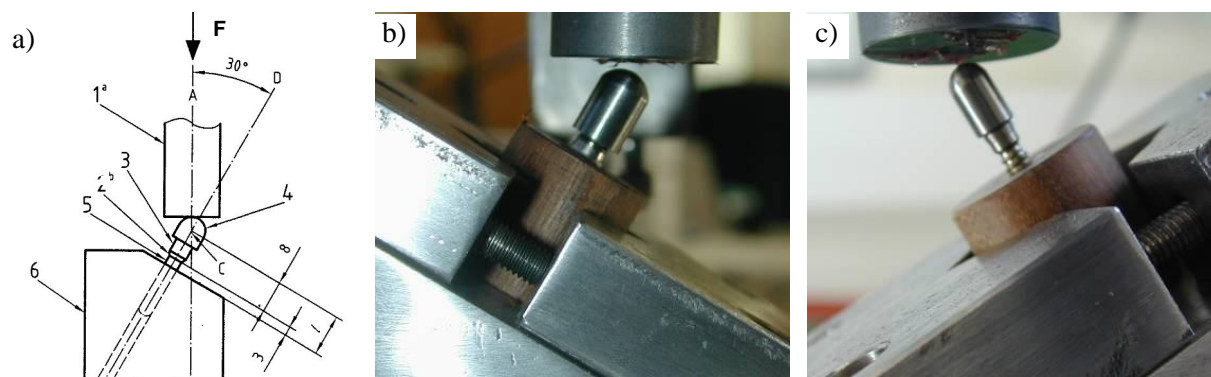
Figura 2. a) Esquema de ensayo: 1-dispositivo de carga, 2-nivel nominal del hueso, 3-pilar, 4-casquillo semiesférico, 5-implante dental, 6-medio de fijación; b) Muestra CI, montada en la máquina de ensayo; c) Muestras HE, montada en la máquina de ensayo.
