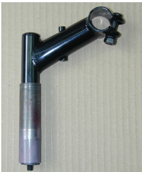
Fig. 4: Portamanubrio ensamblado para determinar el alargamiento del tornillo de expansión.
