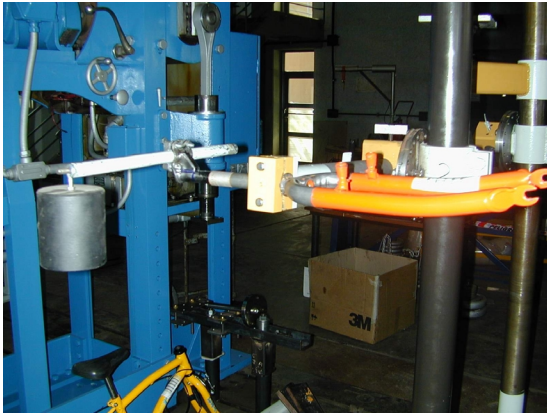
Fig. 3: Ensayo de ajuste portamanubrio – horquilla.
