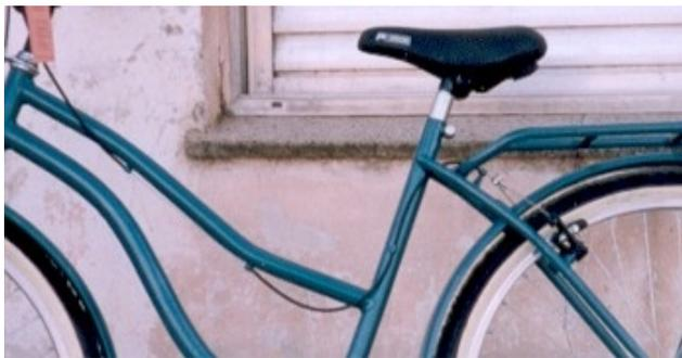
Fig. 6: Cableado trasero en bicicleta dama (Cantilever).
