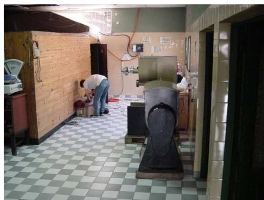
Fig. 1 La planta de elaboración: a la izquierda la cámara de madera donde se secan los fideos. Con nuestra modificación solo se usa una tercera parte. Sobre el techo de la cámara se instaló el equipo de reacondicionamiento dentro de una estructura a dos aguas que apenas se ve.
