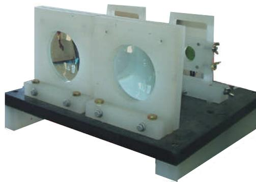
Fig. 1: Sistema óptico de recepción.
