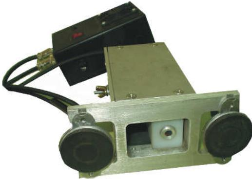
Fig. 2: Dispositivo emisor láser.
