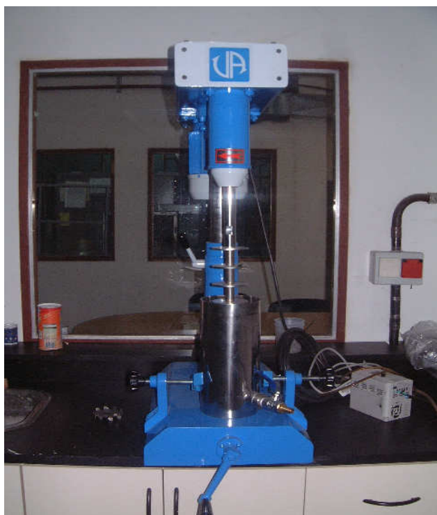
Fotografía N° 1: Dispensora de alta velocidad con molino de perlas adosado al equipo.
