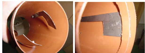
Fig. 1: Los electrodos de acero inoxidable son sujetados por un anillo plástico (derecha). En la nueva versión los electrodos son trapezoidales.
