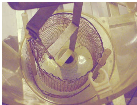
Fig. 1: Vista en planta del tanque electrolítico: ánodo, cátodo, pared y paleta mecánica.
