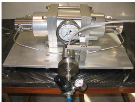
Homogeneizador de alta presión para preparar liposomas, emulsiones, sistemas micelares y nanopartículas (INTI – Química).
