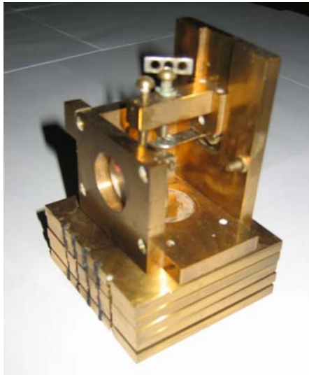
Microscopio de efecto túnel desarrollado en INTI, junto con Magiclick, presentado en 1987 como "Battery Operated STM".
