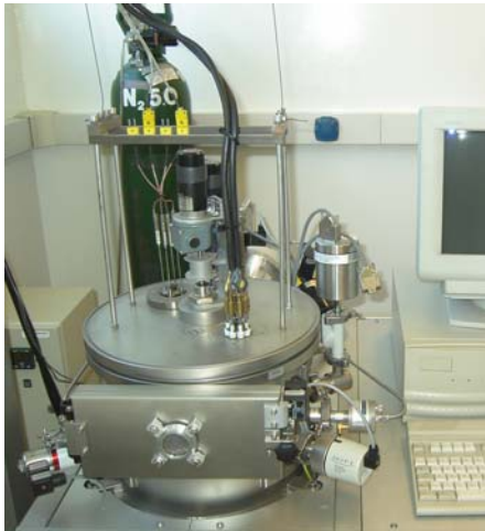
Equipo PVD LS 320 S Von Ardenne para depositar multicapas de metales, recubrimientos nanoestructurados, aleaciones, recubrimientos biomédicos, duros, superduros, materiales no-conductores lubricantes sólidos. INTI – Mecánica.
