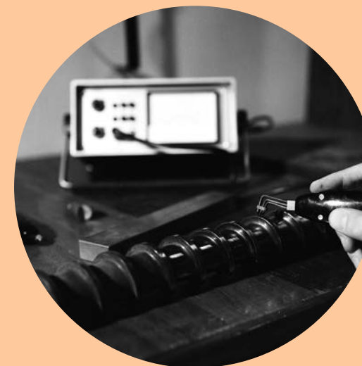
Laboratorio de corrientes inducidas que permite encontrar discontinuidades y fallas en los materiales.
