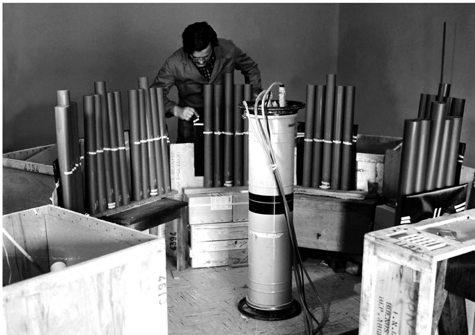
Control radiográfico de granos propulsantes de proyectiles en el Laboratorio de Ensayos No Destructivos.
