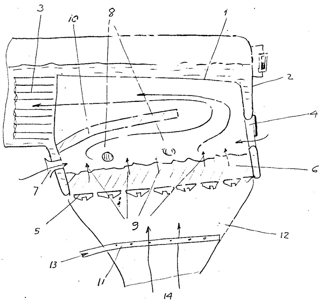
Fig. 2 El sistema de combustión "a la gasogena".
