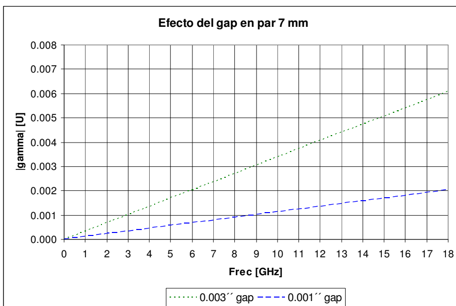
Gráfico 5: Variación del coeficiente de reflexión con el gap – conector 7 mm
