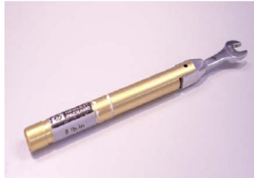
Figura 34b: Llave torquimétrica para conector 3.5 mm
