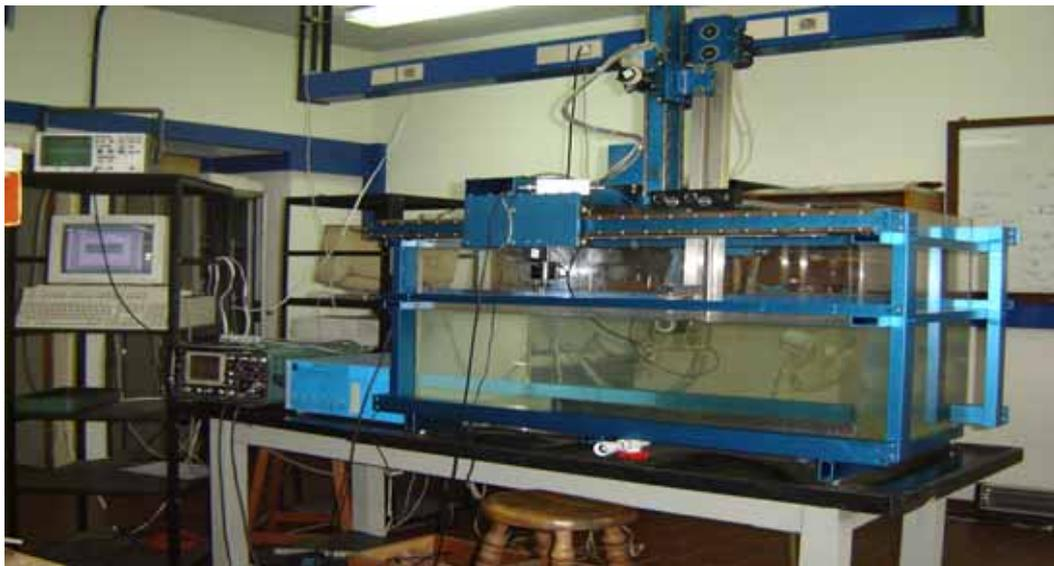
**Figura 5.12:** Banco acústico de precisión para medición del campo acústico
