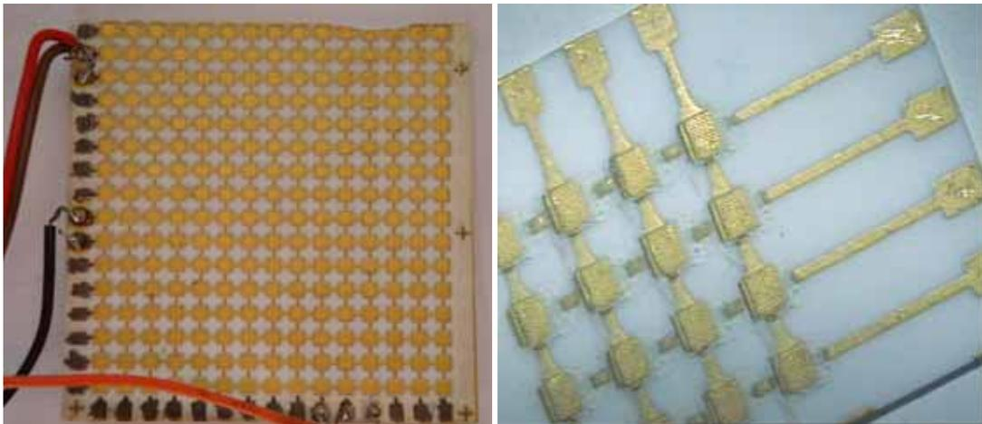
**Figura 6.7:** Fotos de arreglos bidimensionales de transductores sobre alúmina
