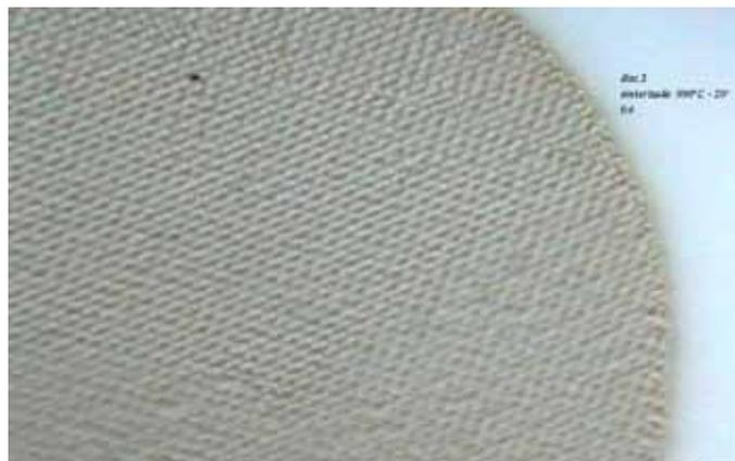
**Figura 4.3:** Superficie de PZT sinterizada sin electrodo superior.
