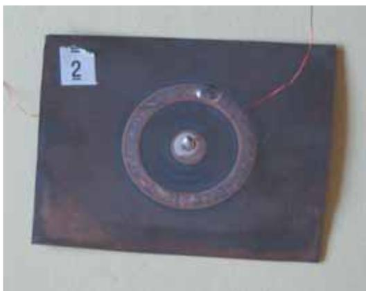
**Figura 6.2a:** *Transductor circular y en anillo sobre sustrato de acero inoxidable*
