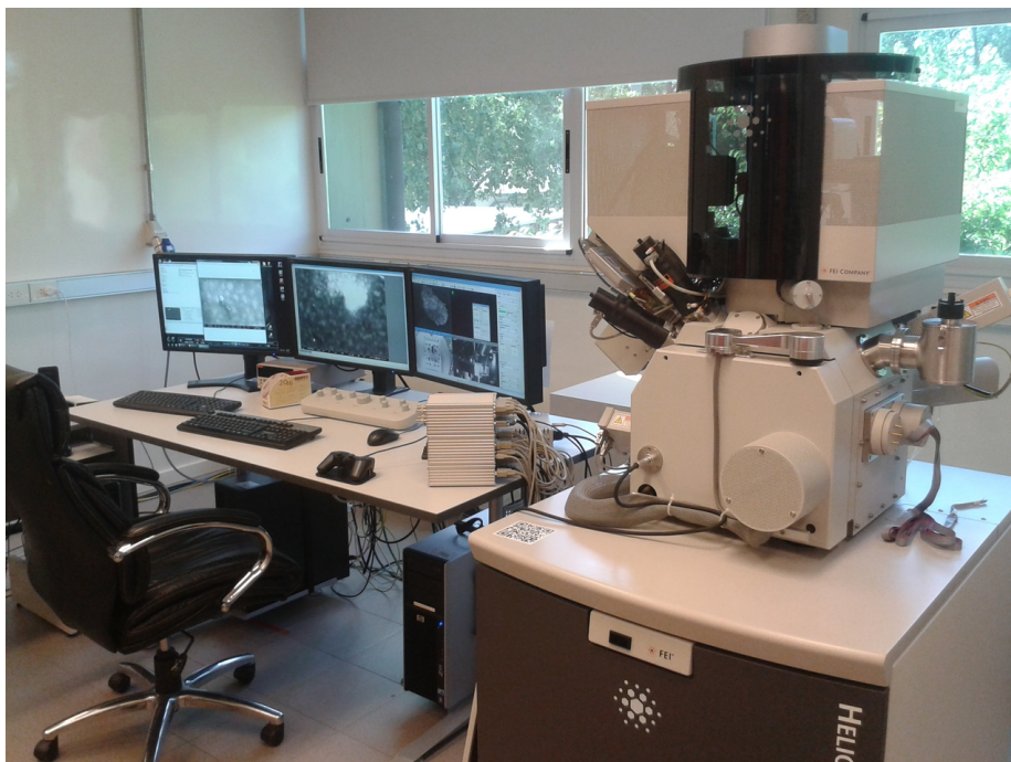
Figura 2.15: Equipo de FIB/SEM utilizados para realizar las observaciones, cortes y caracterizaciones de los sensores. Consta de un microscopio de barrido electrónico de alta resolución y de una fuente de galio líquido para realizar, entre otras cosas, cortes en la micro y nanoescala.
