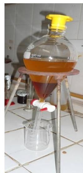
**Fig.3:** separación biodiesel-glicerina
