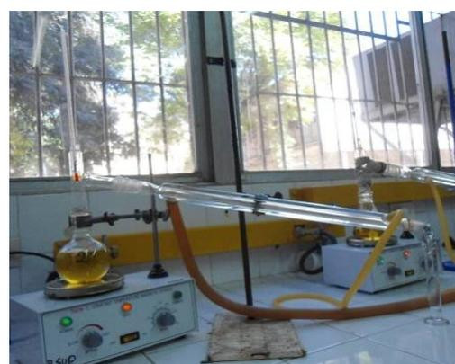
**Fig.2:** Equipo utilizado en la producción biodiesel
