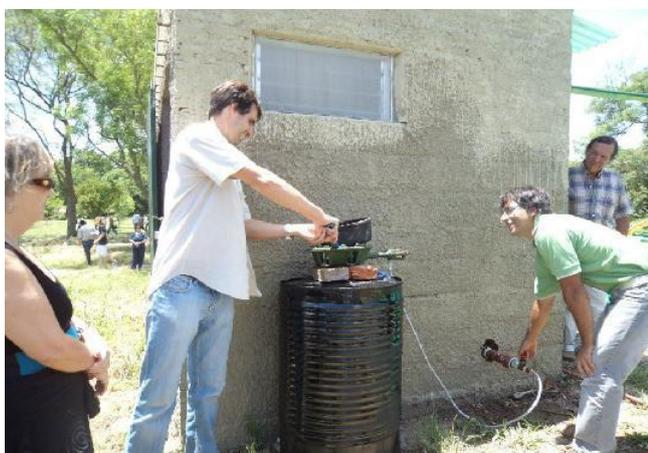
Foto 3: Encendido del quemador adaptado para funcionar con biogás
