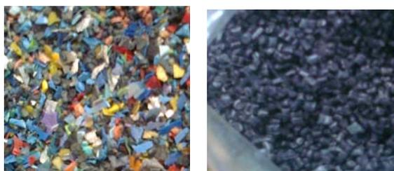
**Figura 1.** Plástico molido y luego pelletizado
