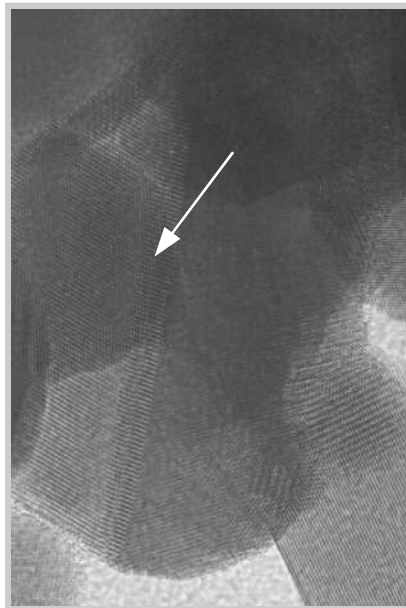
Fig. 4.28 | Terrazas en la superficie de cristales de SnO 2 puro obtenido mediante Ruta II
