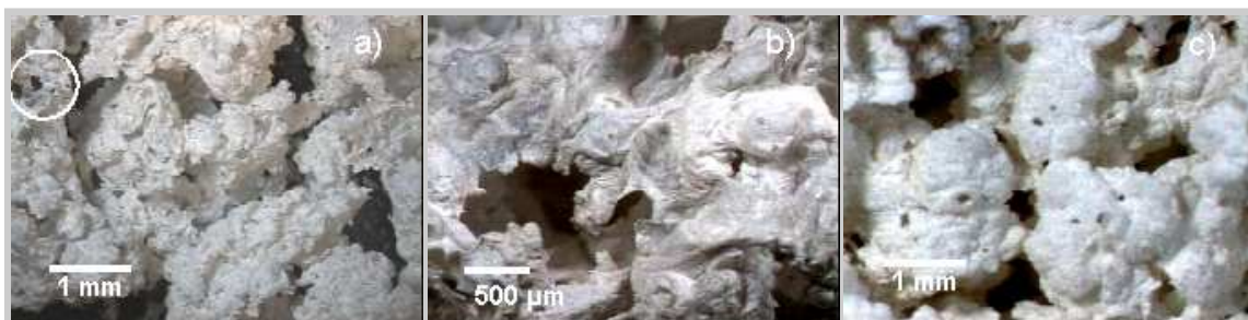
Fig. 4.11 | Imágenes estereoscópicas de polvos de SnO 2 obtenidos mediante ambas rutas con relación molar 1:6 [estaño / combustible], temperatura de ignición de 850°C y calcinación de 600°C durante 60 min. a) Ruta I (partiendo de Sn metálico). b) Magnificación del círculo indicado en (a). c) Ruta II (partiendo de dicloruro de estaño acuoso).
