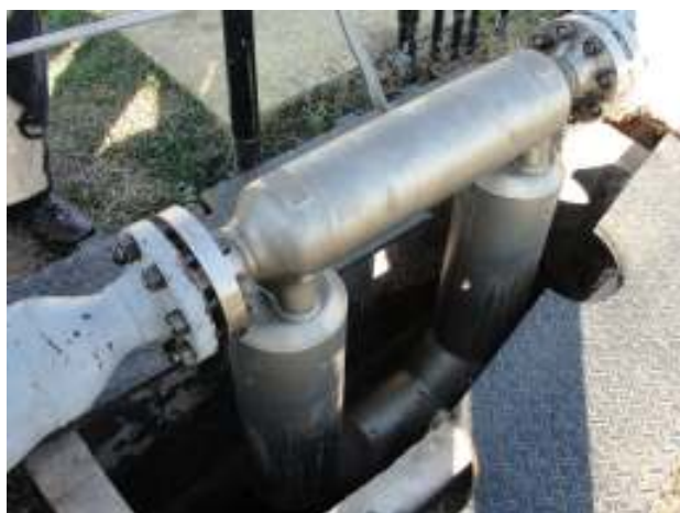
Fig. 2 Medidor Coriolis empleado para la medición.
