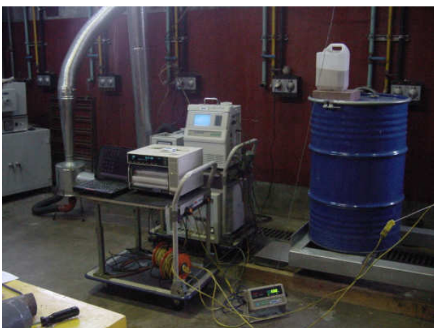
Figura 4 Sistema de monitoreo y adquisición de datos. Análisis de gases de combustión.
