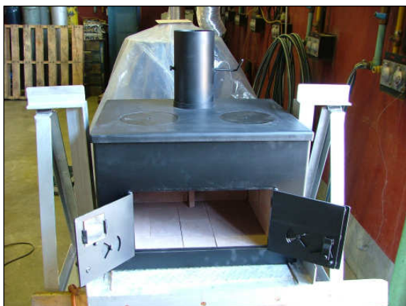
Figura 2 El calefactor multifunción en la plataforma de ensayos de INTI-Energía.
