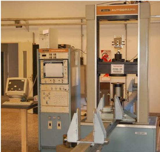
Fig. 1: Equipo para ensayo de maderas perteneciente al centro INTI-Maderas.
