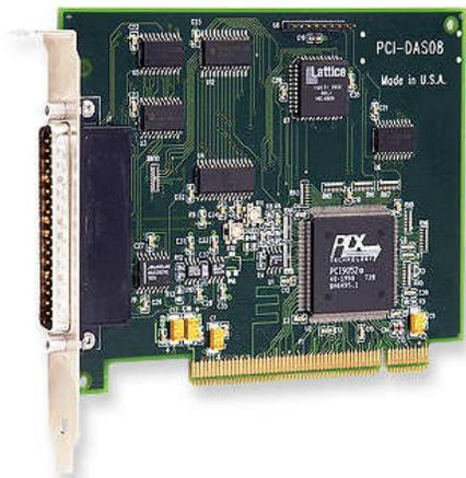
Fig. 2: Placa de adquisición PCI-DAS08.
