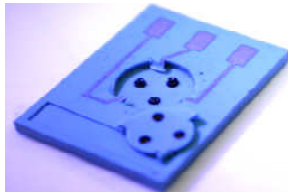
Fig. 7. Fabricación del sensor con contactos externos.
