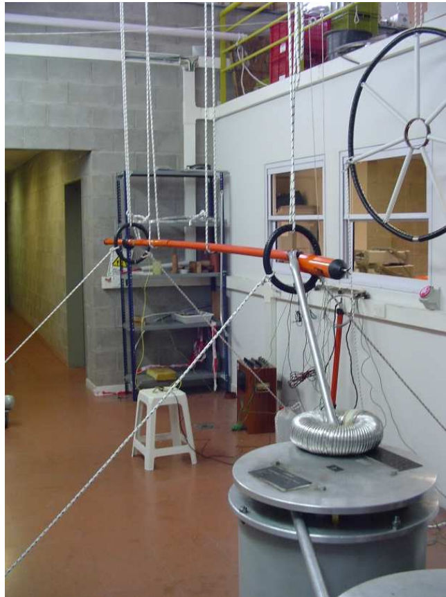
Ensayo de detectores de tensión según Norma IEC 61243
