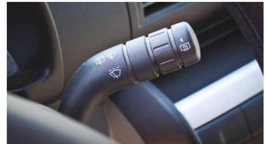
En el caso del automóvil, donde el conductor está concentrado en el manejo, los comandos integrados al volante deben ser de un uso predominantemente intuitivo, con una fuerte similitud de comportamiento entre el comando y el efecto. Además, se apela a “señales” táctiles y auditivas, dado que el sentido de la vista está centrado en otros focos de atención.
