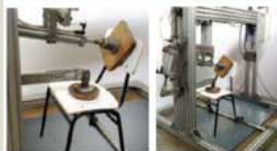
Prueba de impacto contra las patas de las sillas
