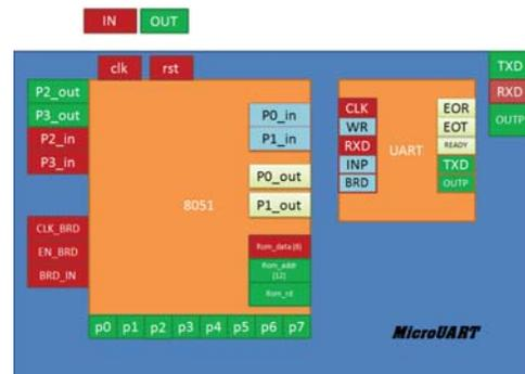
Figura 1. Diagrama en bloque de la instancia microcontrolador e interfaz de comunicación serie.
