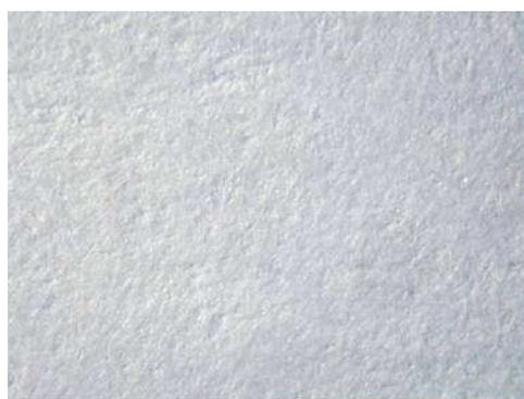
**Figura I. 4:** Superficie Papel obra NSSC calandrado en laboratorio (12x)
