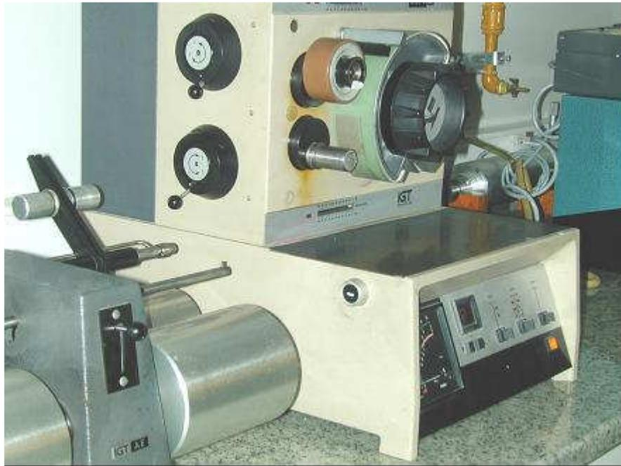
**Figura 10** : Aparato para medir calidad de impresión IGT
