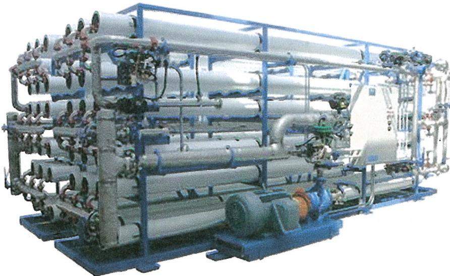
Las membranas comúnmente utilizadas para el tratamiento de agua son membranas en espiral dispuestas en una configuración que permita alcanzar la conversión y el caudal de permeado requerido. Generalmente se colocan de 2 a 6 membranas por módulo y pueden utilizarse más de una etapa para lograr una mayor conversión.
