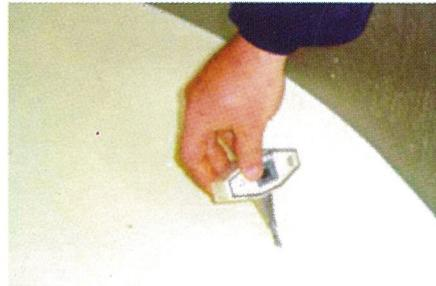
**Figura 5.** Termómetro incorporado al equipo de refrigeración para la medición automática de la temperatura de la leche.
