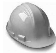
Un casco debe asegurar buena resistencia a la penetración y suficiente amortiguación. La resistencia a la penetración está condicionada por la cáscara que se considera rígida, mientras que la amortiguación del impacto es producida por el arnés ubicado en el interior de la cáscara. Ambos elementos están unidos entre sí por medio de trabas especiales.
