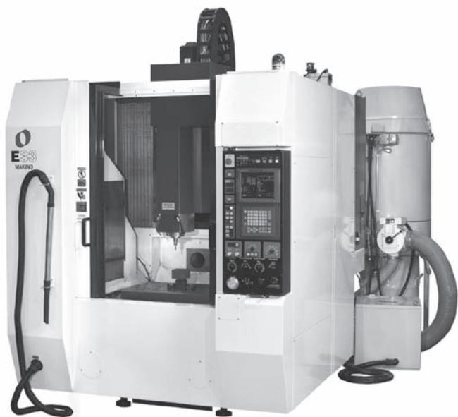
Figura 67: Centro de mecanizado Makino E33, para grafito y aceros templados, dotado de un husillo de 40.000 rpm y sistema de aspiración de polvo.
