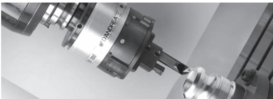
Figura 35: Cabezal D'Andrea montado en centro de mecanizado para el perfilado de componentes de revolución.
