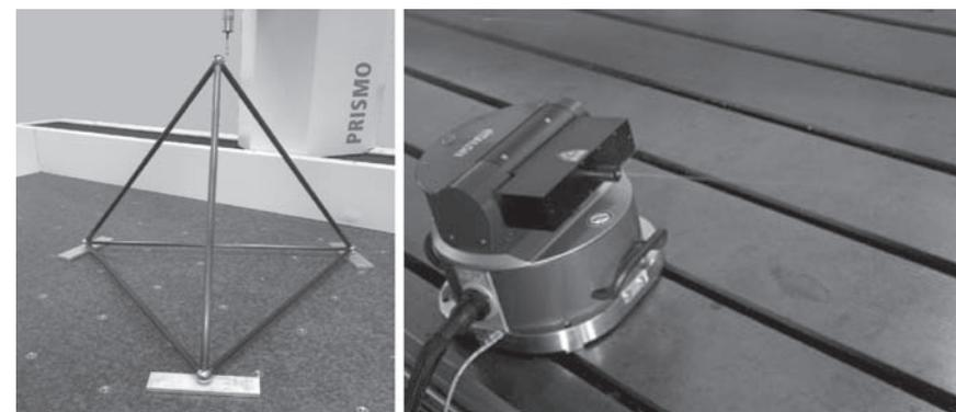
Figura 51: Artefactos 3D para mediciones de error entre ejes y Láser Tracer de la empresa Etalon®
