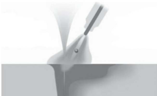
Fig. 7.19: Esquema del proceso de soldadura híbrida Láser-GMA.
