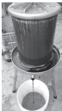
Figura 3: Hidroprensa para obtención de extractos (costo promedio 500 USD)
