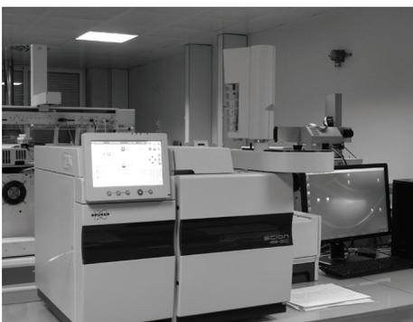
Figura 12: Cromatografo de Gases Bruker
