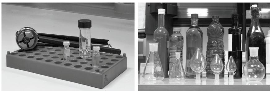
Figura 14: capsulador, microvial y vial de cromatografía. Matraces
