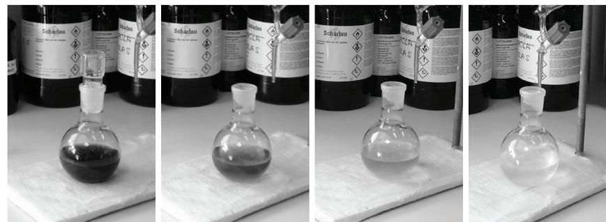
Figura 10: Fases de la valoración con tiosulfato sódico 0.01N
