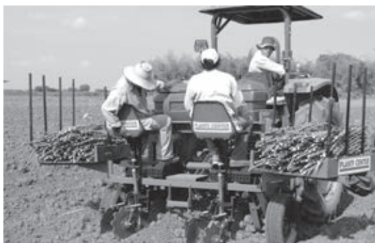
Maquinaria de dos líneas para la siembra de estacas de mandioca (Planticenter-Bazuca 1).
