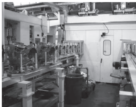
Figura 28: Cinta transportadora de pallets que ingresan a la máquina para ser mecanizadas.
