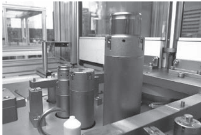
Figura 41: Base o plataforma de localización de la pieza en la máquina de medir.
