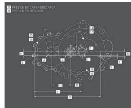
Figura 36: Características a medir en la carcasa de embrague.
