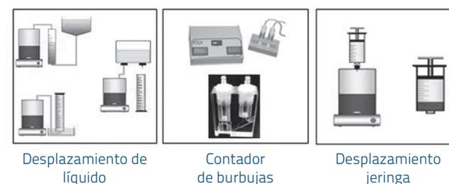
Figura 20. Métodos utilizados para realizar ensayos anaeróbicos.
