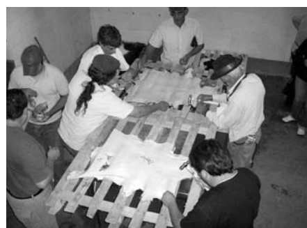
Estirado de las pieles en bastidores de madera para el secado de la piel al aire
