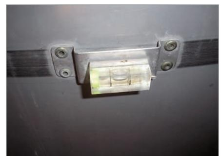
Figura 9. Nivel de burbuja adosado a un tanque enfriador.
