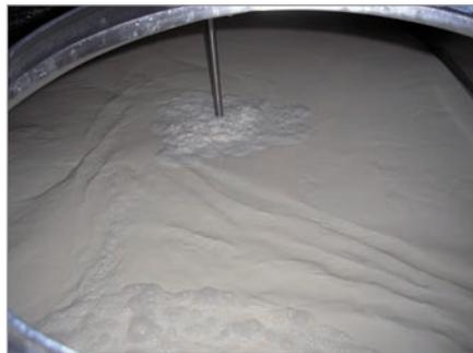
Figura 13. Leche en agitación dentro de un tanque enfriador.
