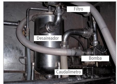
Figura 16. Sistema de medición con caudalímetro.
