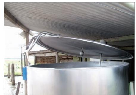
Figura 5. Tanque con regla interna extraíble y regla.
